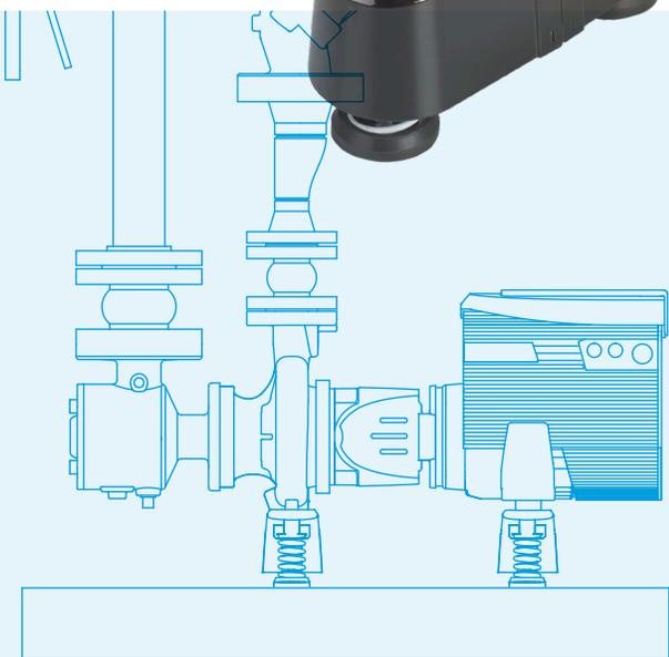
O isolamento integral das vibrações elimina a necessidade de bases de inércia ou placas de base. As seguintes características minimizam a transmissão de vibrações:
