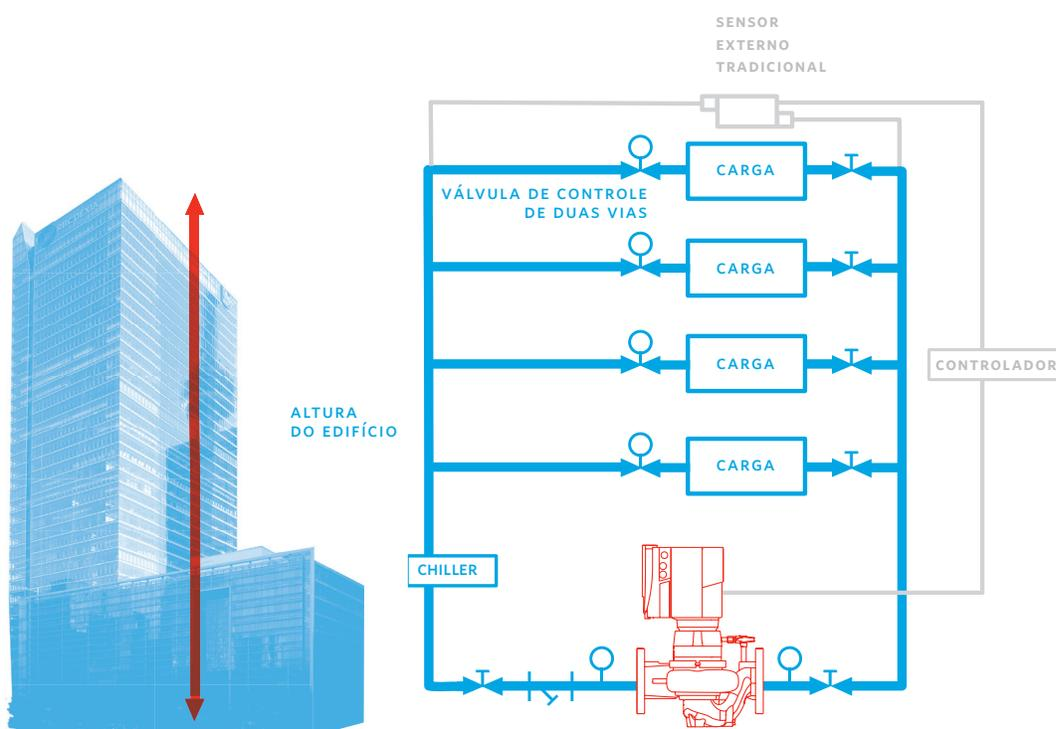
Equipadas com tecnologia Sensorless, as soluções Design Envelope não requerem um sensor externo para monitorar e controlar a carga do HVAC.
