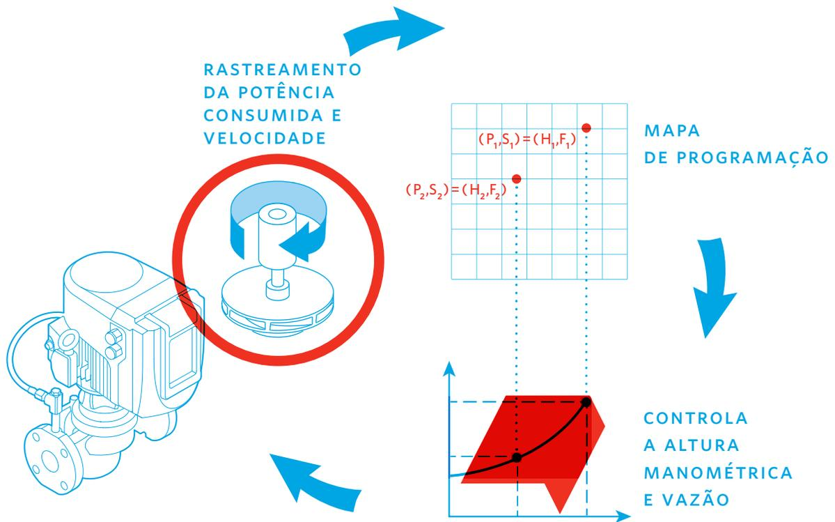
**Equipado com a tecnologia Sensorless as soluções Design Envelope não exigem um sensor externo para monitorar e controlar a carga de HVAC.**
