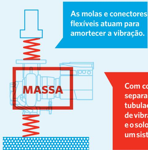
Com conectores flexíveis separando a bomba da tubulação, e isoladores de vibração entre a bomba e o solo, a bomba flutua em um sistema de mola isolada.
