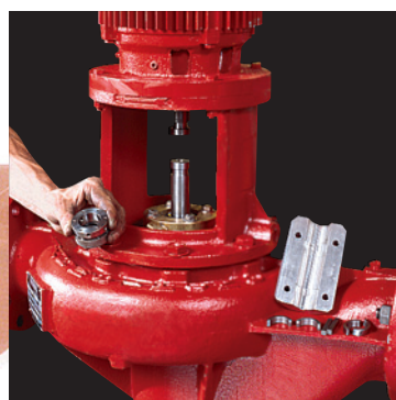
4) 现在可以安装新密封。反向执行上述步骤：安装新密封、装回压盖板和耦合器，然后重新启动泵。刚性耦合器保持出厂时的对准情况。
