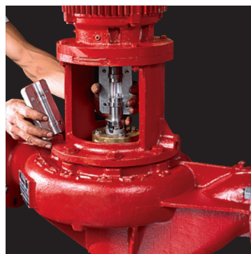
2) 拆下耦合螺栓：从马达轴和泵轴上取下一半耦合器（带有传动装置和使用期为一年的定位键）。松开密封旋转件上的紧定螺丝，并从泵轴上滑出。（对于内置式密封，请参阅步骤3）
