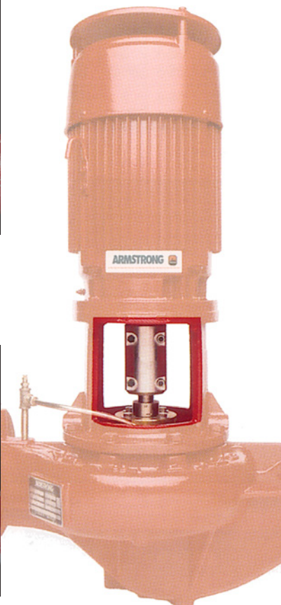
1) 带外置密封的对开耦合器。图示为拆下耦合护板后的轴向对开耦合器。耦合螺栓仍在原位。可以看到，密封旋转件在耦合器之下、压盖板之上。
