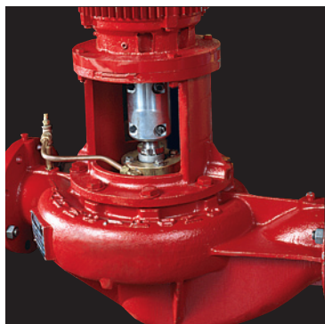
1) 带外置密封的对开耦合器。图示为拆下耦合护板后的轴向对开耦合器。耦合螺栓仍在原位。可以看到，密封旋转件在耦合器之下、压盖板之上。
