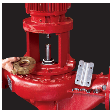
3) 断开密封冲洗管，并拆下压盖板螺栓。然后就可以从轴之间取出压盖板和密封座。对于内置式密封，在取下压盖板后才能拆下整个密封。
